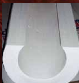
oben: Prinzip Gießrinne mit integrierter Heizung unten: Rinne-in-Rinne-System für minimale Wärmeverluste
